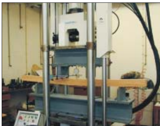
Ensayo de resistencia a flexión. Fotografía: Nuno Ribeiro
