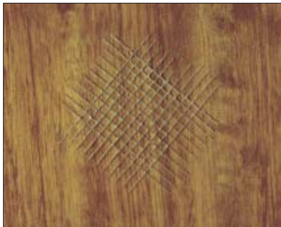
Ensayo de resistencia superficial al daño mecánico por corte cruzado sobre madera de eucalipto. Fotografía: Mani Moretón
