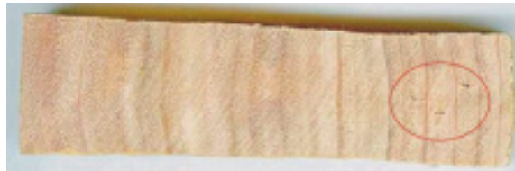
Presencia de fendas internas localizadas en la madera de primavera
