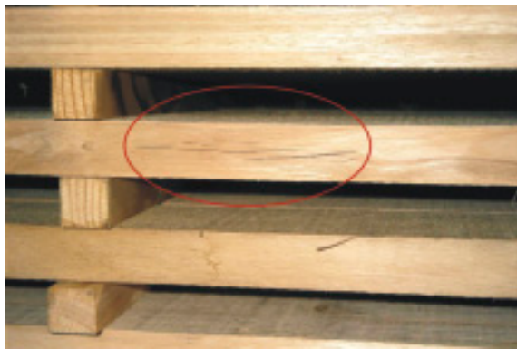
Fendas superficiales producidas, al iniciarse el secado, en las proximidades de la médula
