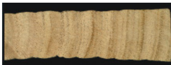
Manifestación del colapso en un despiece radial
