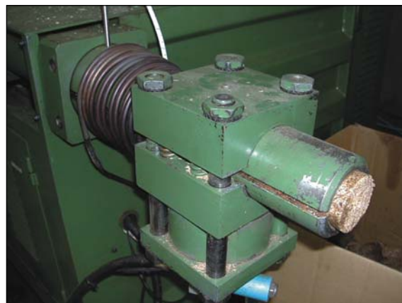
Detalle de cabezal de briquetado
