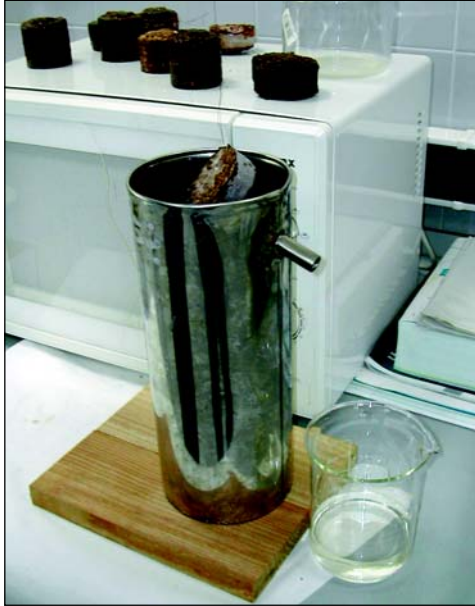
Medición de la densidad de las briquetas
